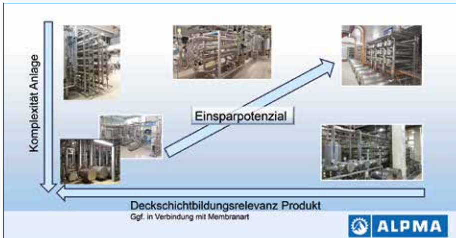
Bild 5: Anlagenclassifizierung nach Komplexität und deckschichtbildenden Substanzen
